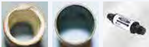
Wasserleitungsrohr mit Kalkablagerungen und nach Einsatz eines H.Preiss aquaSpin.
